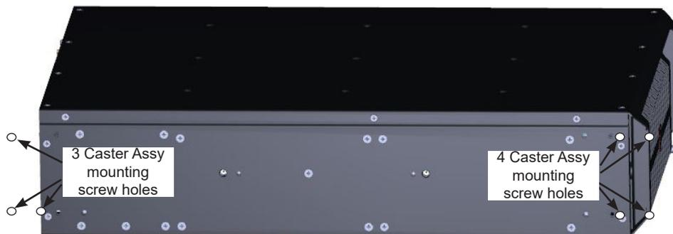
FIGURE 3: POSITION MODULE FOR CASTER INSTALLATION
